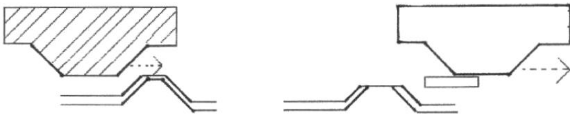
(fig. 27 : Une aspérité dure se déplace par rapport à une surface)
